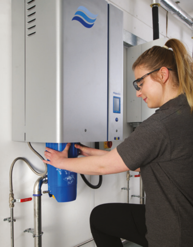
Isıtma elementlerinin üstünde oluşan tortu ayrılır ve kolayca uzaklaştırılabileceği tortu toplama tankına düşer.
